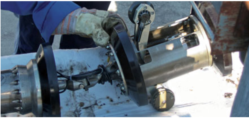
Abb. 5 Ultraschallmolch: Speicher und Wegmessung
