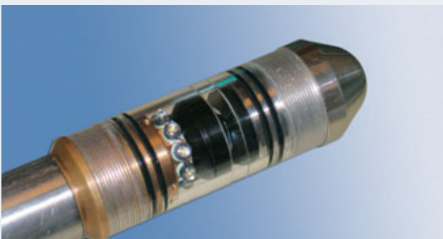
Optische Scanner zur Erfassung von Brunnen und Bohrungen arbeiten mit Zeilenkameras und beson- ders hellen LEDs.
