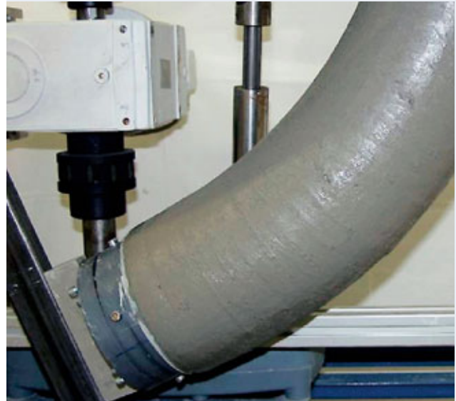
Grundlagenuntersuchung: Durch die Herstellung von Endlossträngen werden auch textilbewehrte Verbundrohrbögen möglich.
