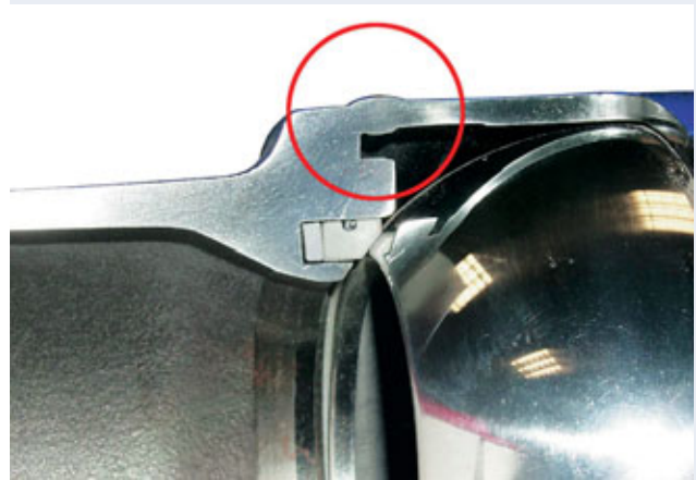
Über den ganzen Querschnitt durchgeschweißte Nähte tragen zur Beständigkeit von erdverlegten Kugelhähnen in Fernwärmeverteilungsnetzen bei.
