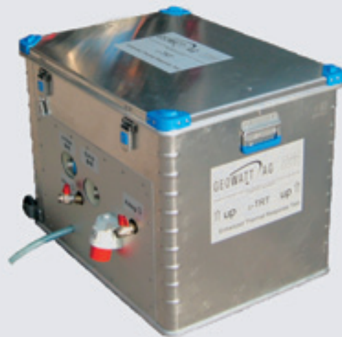
Abb. 4 TRT-Gerät der GEOWATT AG (0,83 m x 0,64 m x 0,61 m, 63 kg). Die Leistung kann stufenlos von 0 kW bis 10 kW eingestellt werden. Heizleistung und Zirkulation können unabhängig voneinander reguliert werden. Die Genauigkeit der elektrischen und hydraulischen Leistungsmessung beträgt 1 bzw. 1,5 Prozent.
