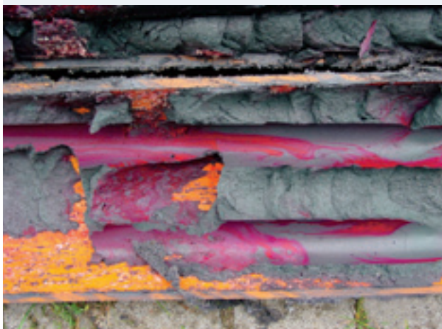
In Modellversuchen wurde das hydraulische System- verhalten der gesamten Erdwärmesonde (Sonden- verrohrung und Verpressmaterial) untersucht.
